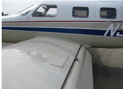
Zwei Varianten von Bremsklappen stehen PA-46-Kolbenflugzeuge als Nachrüstung zur Verfügung. Oben Spoilers Inc., unten: Precise Flight.
