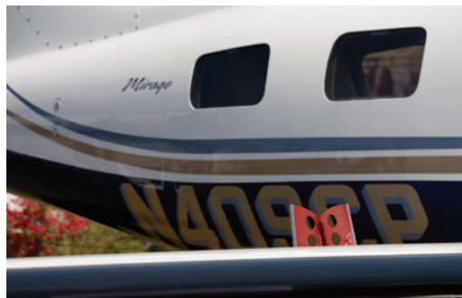
Zwei Varianten von Bremsklappen stehen PA-46-Kolbenflugzeuge als Nachrüstung zur Verfügung. Oben Spoilers Inc., unten: Precise Flight.
